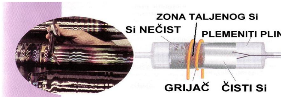
Slika 6.3.11. Dobivanje ultračistih materijala ( w(\text{Si}) = 99,999999 \% ) /28/
