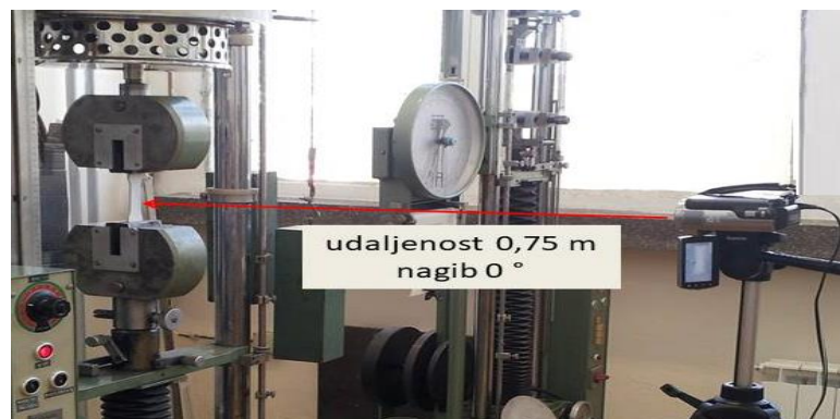
Slika 2.23. Raspored opreme kod ispitivanja metodom DIC [11]
