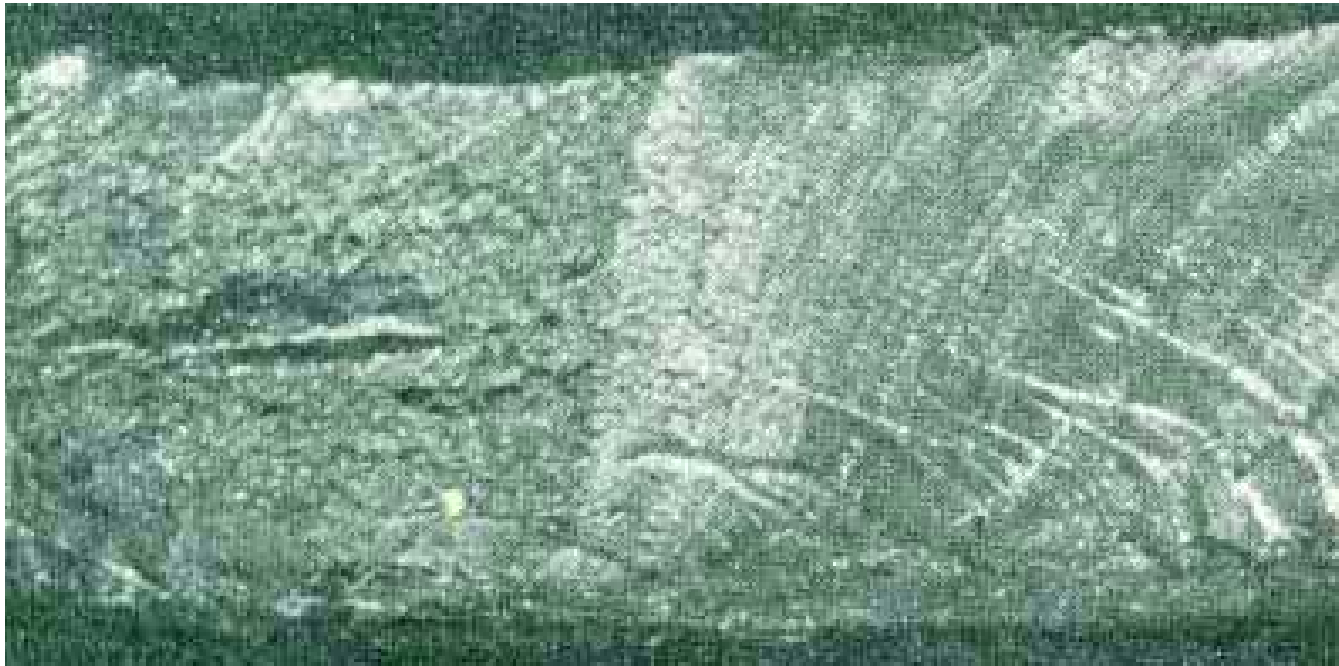
Slika 5.2: Lom od umora materijala
