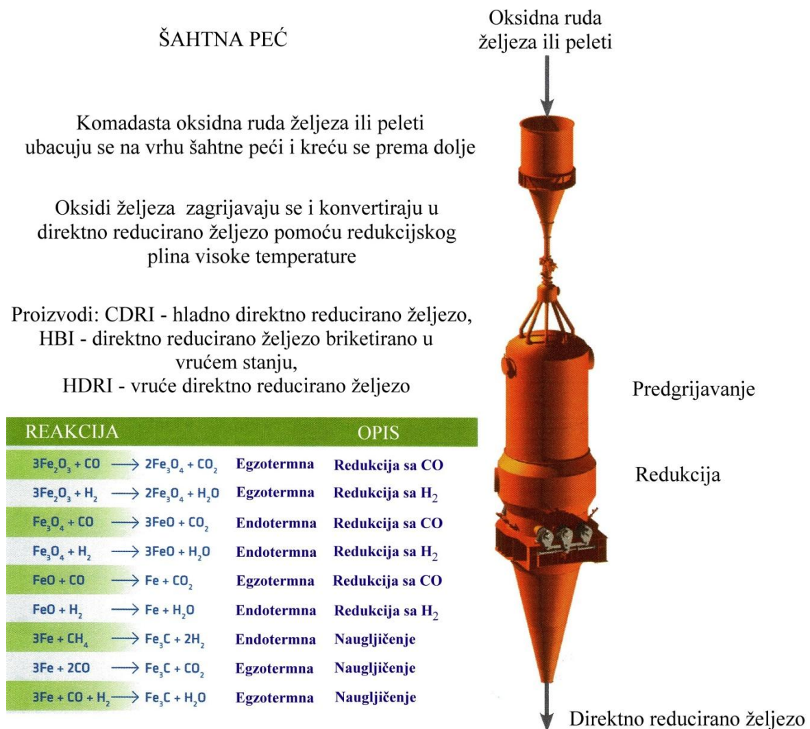
Slika 7.3. Reakcije koje se odvijaju u MIDREX ® šahtnoj peći [15]
