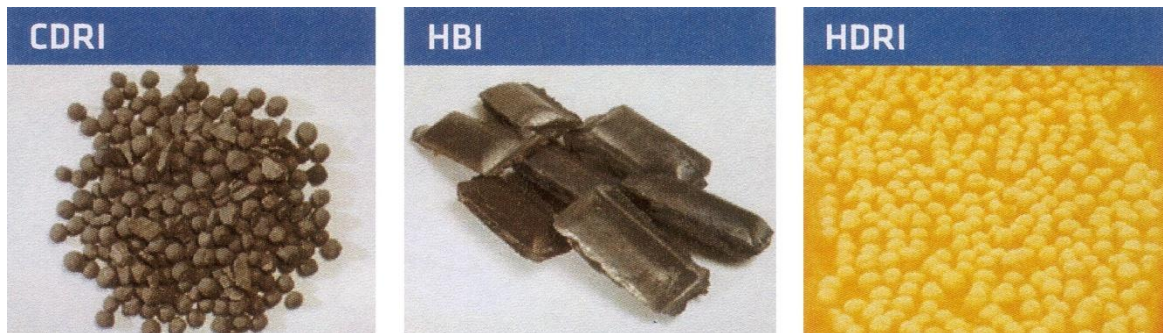
Slika 7.1. Proizvodi direktne redukcije (CDRI – hladno direktno reducirano željezo, HBI – direktno reducirano željezo briketirano u vrućem stanju, HDRI – vruće direktno reducirano željezo) [15]
