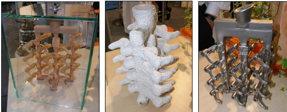
Slika 11.44. Livni grozd, keramički školjkasti kalup i odliveni odljevci
