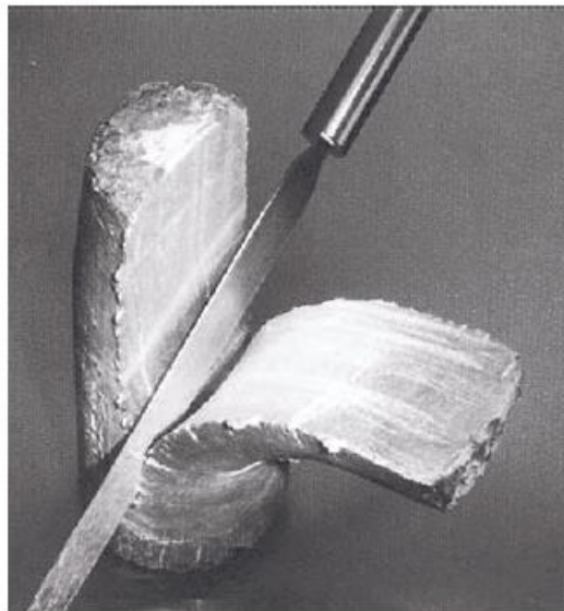
Slika 13.16. Pravilno zagrijan valjkasti poluproizvod u djelomično rastaljenom (tjestastom) stanju lako se, poput maslaca reže nožem [122]
