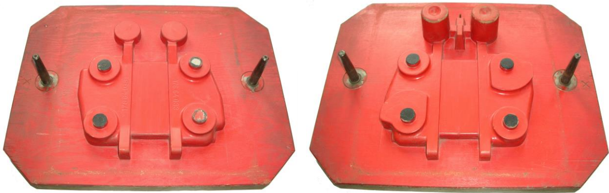
Slika 11.3. Jednostrane modelne ploče izrađene od drveta, tj. donja i gonja modelna ploča za izradu kalupa s horizontalnom diobenom ravninom
