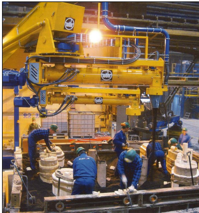
Slika 11.41. Primjena vijčanog kontinuiranog mješača pri izradi kalupa od kemijski vezane mješavine [96]
