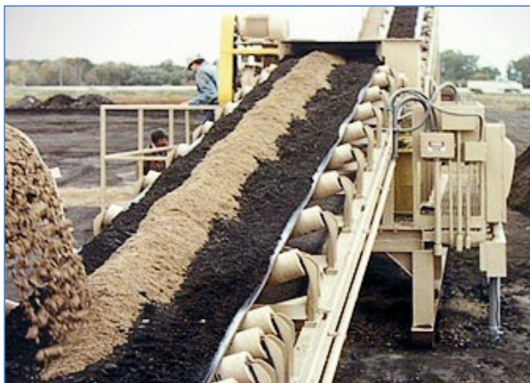
Slika 76. Miješanje onečišćenog tla s reagensima za stabilizaciju 133
