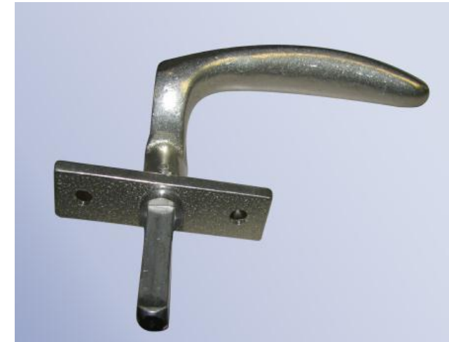
Ukrasna kvaka – lijev u pijesak s isprintanim modelnim pločama
