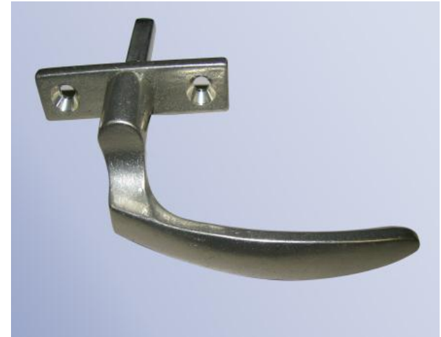
Ukrasna kvaka – lijev u pijesak s isprintanim modelnim pločama
